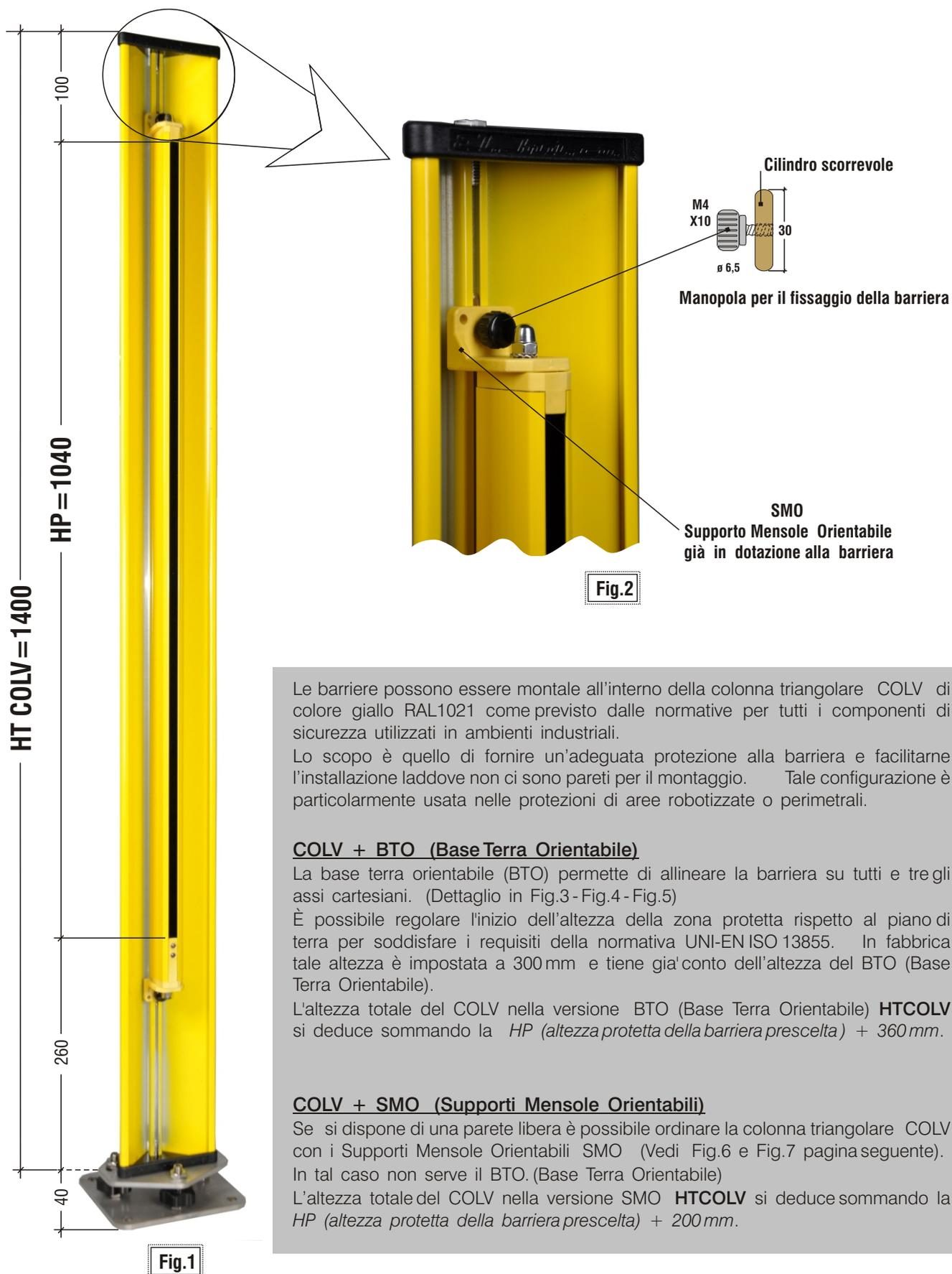
Le barriere possono essere montate all'interno della colonna triangolare COLV di colore giallo RAL1021 come previsto dalle normative per tutti i componenti di sicurezza utilizzati in ambienti industriali.
